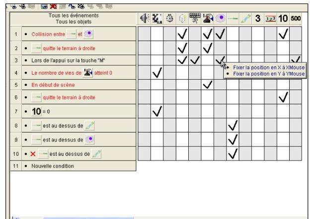
**Figure 36 :** Présentation des événements (lignes) et des objets (colonnes) sur lesquels les actions se font (présence de coches) sous forme de tableau dans MMF 2. Cette présentation permet une vision globale des interactions. Un survol des coches par la souris permet aussi de connaître le détail des actions.
